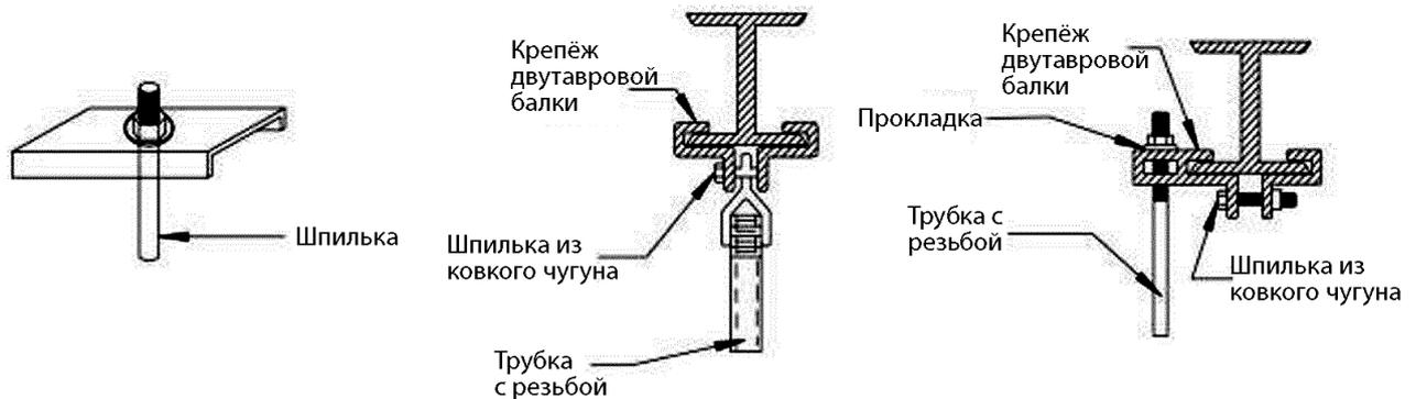
Рис. 3В Крепление нагревателя при монтаже
